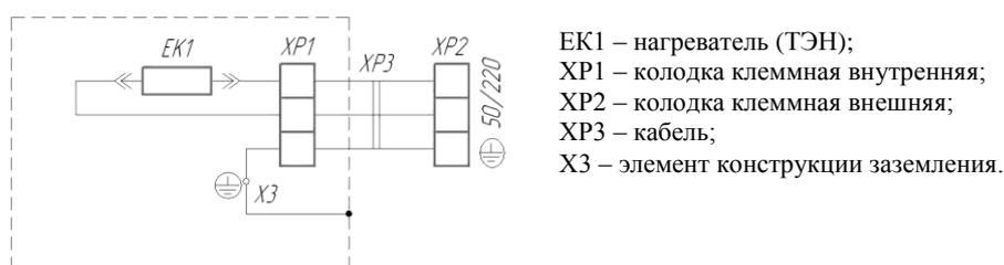
Рис.2 Электрическая схема
