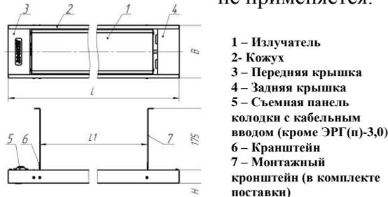
Рис. 1 Обогреватель панельного типа.
