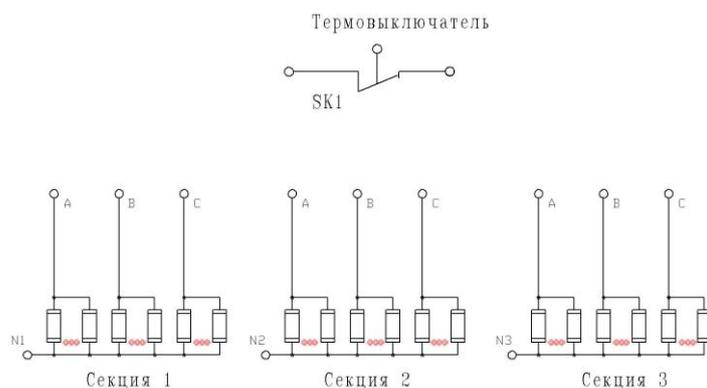
Рис.1 Схема электрического соединения ТЭН в секции электрокалорифера
